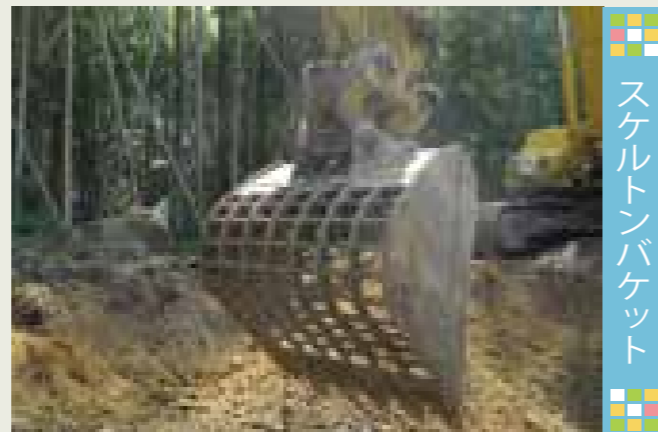
対象物をふるって選別するバケット ・伐根作業時
